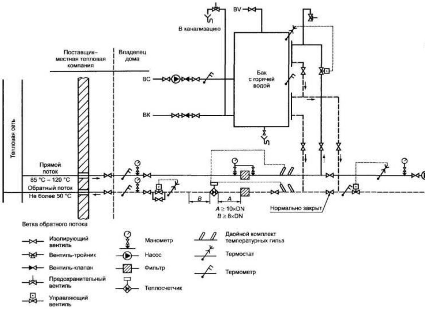
Рисунок А.3 - Отопительная система, прямой тип
