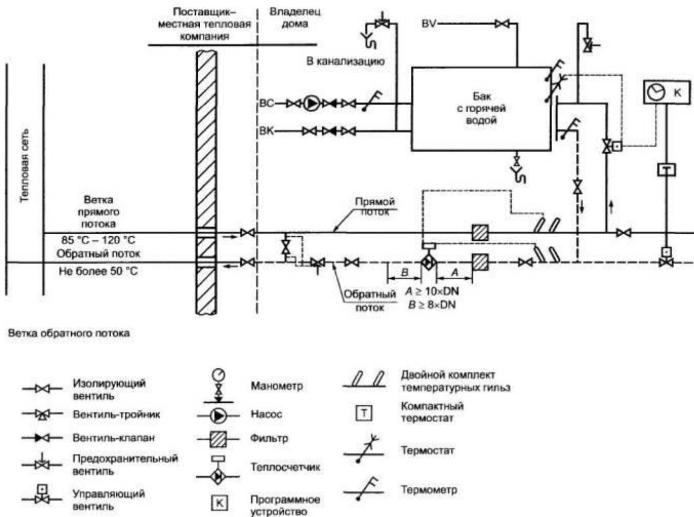
Рисунок А.1 - Типичная отопительная система для дома, прямой тип
