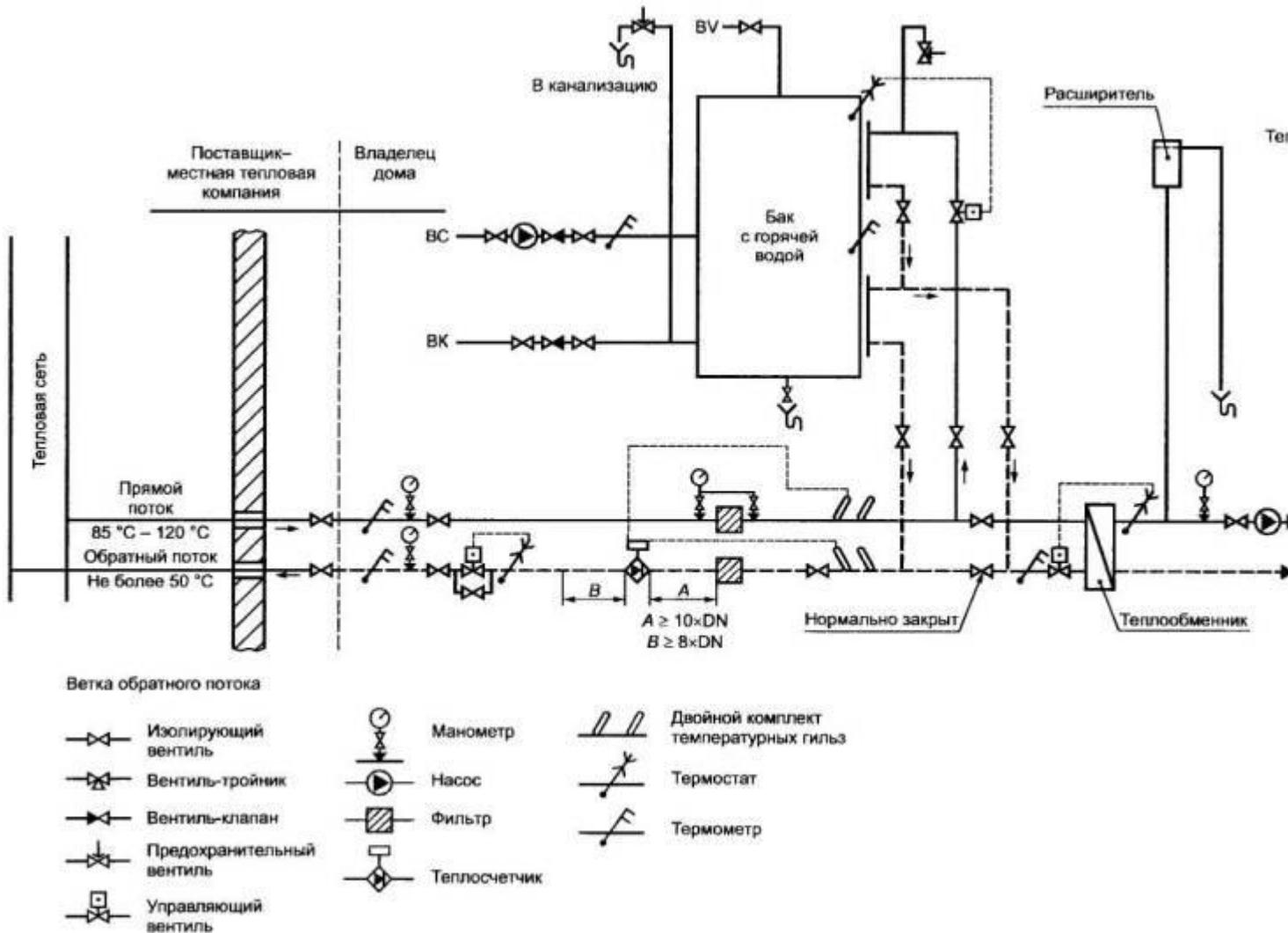
Рисунок А.2 - Отопительная система с теплообменником
