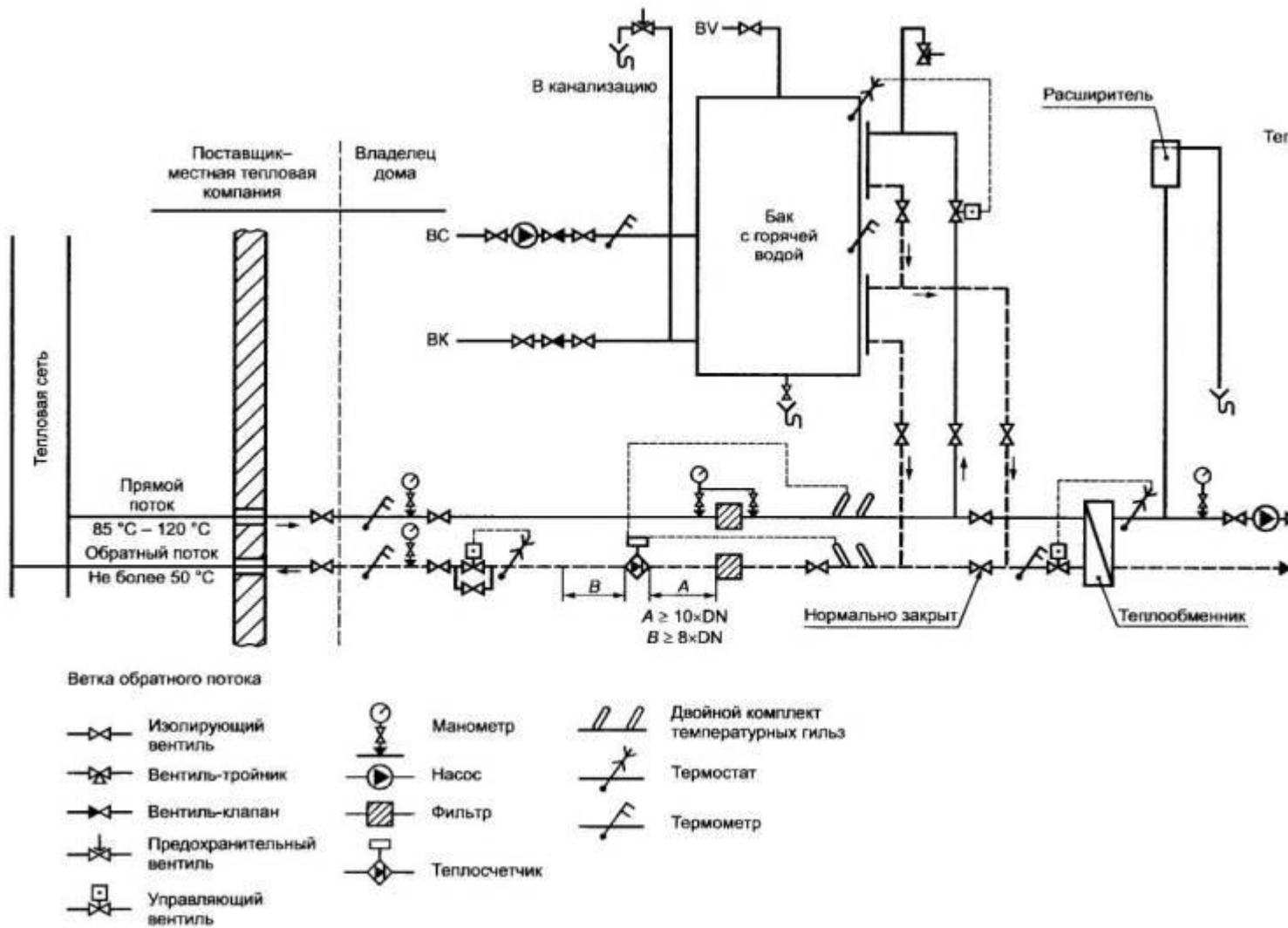
Рисунок А.2 - Отопительная система с теплообменником
